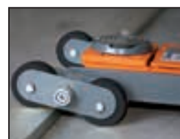
Roți frontale duble, inclinabile, făcute din plastic (PTFE)
